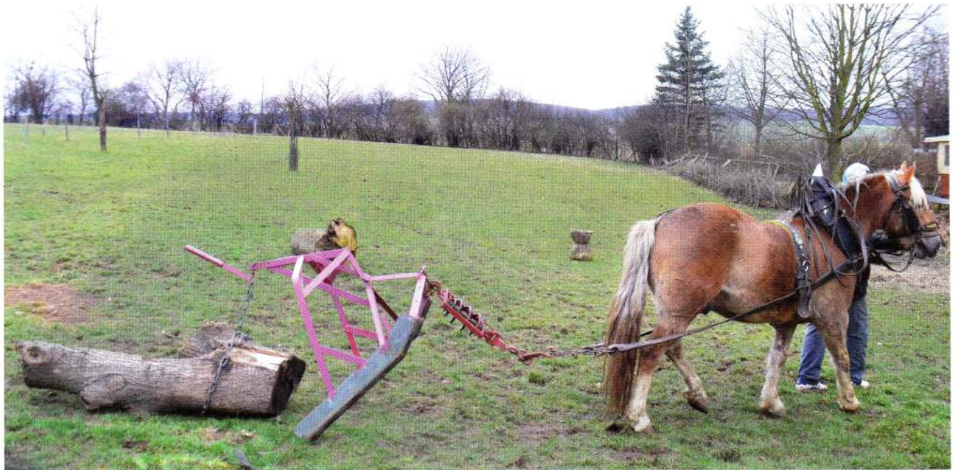
Beim Anziehen wird der Stamm automatisch auf die Schleppe gehoben.
