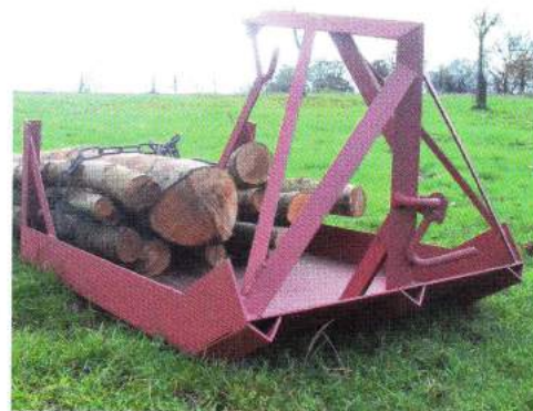
Die schwere Ausführung zum Rücken von stärkeren Stammholzabschnitten.
